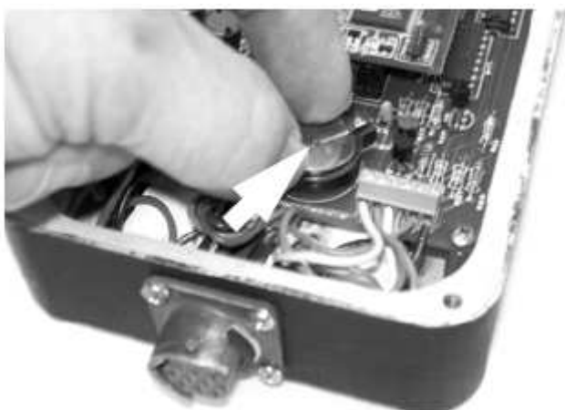
3-20 新电池滑到插槽中,正极朝上.
