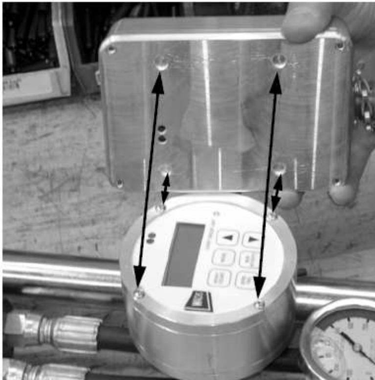
5-31 数据记录器与控制单元在同一个方向上对齐;数据记录器被面的4个孔与控制单元正面的4个螺栓对齐。
