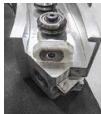
V型锁紧环接合面 防止受力变形
